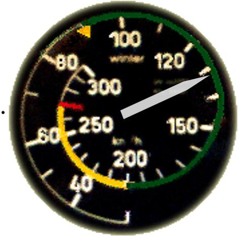
La pression dynamique  $P_d$  générée par l'écoulement de l'air sur le planeur est proportionnelle à la vitesse du planeur,
